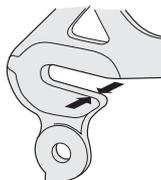
Auf den Schnellspannhebeln von Shimano befinden sich die Bezeichnungen "OPEN" und "CLOSE". Achten Sie darauf, dass der Schnellspannhebel vollständig in die Position "CLOSE" gedrückt ist. Durch Drehen der Einstellschraube können Sie das richtige Anzugsmoment einstellen (die Klemmkraft zur Befestigung am Fahrradrahmen). Nehmen Sie sich Zeit, um die richtige Klemmkraft einzustellen, mit der der Schnellspannhebel vollständig in die Position "CLOSE" gedrückt werden kann.
