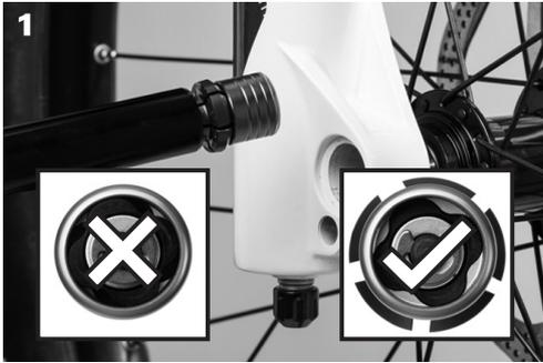
1 vor dem Einbau den Flansch prüfen und den Hebel komplett öffnen
