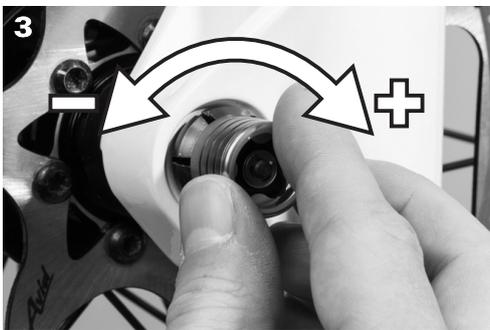
3 Spannung bei halb geöffnetem Hebel einstellen bis der Flansch anliegt
